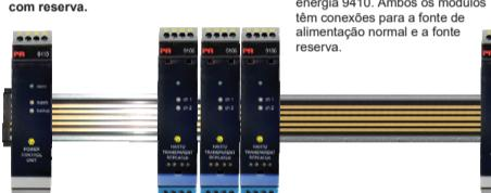
A energia é fornecida ao barramento de alimentação de dois módulos de controle de energia 9410. Ambos os módulos têm conexões para a fonte de alimentação normal e a fonte de reserva.
